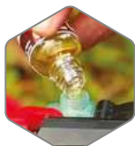
Tanque de aceite para lubricación de cadenas
